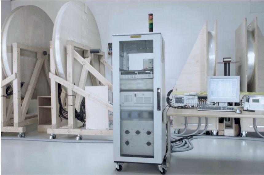
Abb. 14: Helmholtz-Messplatz für die Messung von Abschirmfaktoren
