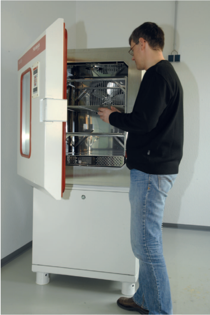
Abb. 18: Messschrank für Temperaturwechsel- und Feuchteprüfungen.
