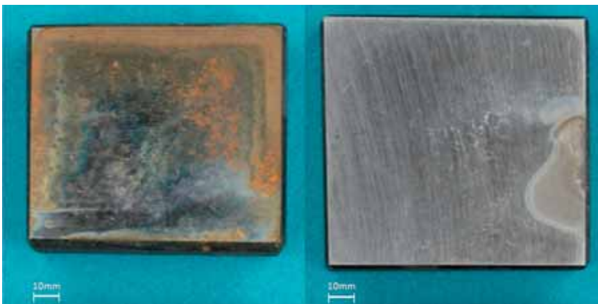
Bild 7. Die FeCoNi-Legierung (rechts) zeigt eine bessere Korrosionsbeständigkeit als ein 1.2343 (links). Die Proben wurden für 24 h in Temperierwasser (pH-Wert: 8,0; Gesamthärte: 5 °dH) bei 85 °C eingelagert (Bild: Vacuumschmelze GmbH)
